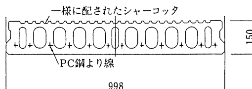
図－2.1 スパンクリート断面図
