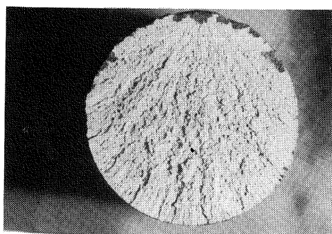
写真－3.3 PC鋼棒破断面拡大状況
