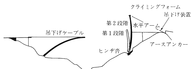
図- 3.63 ロアリング工法によるArgentobel橋の施工
