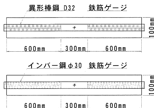
図-16 拘束応力試験供試体
