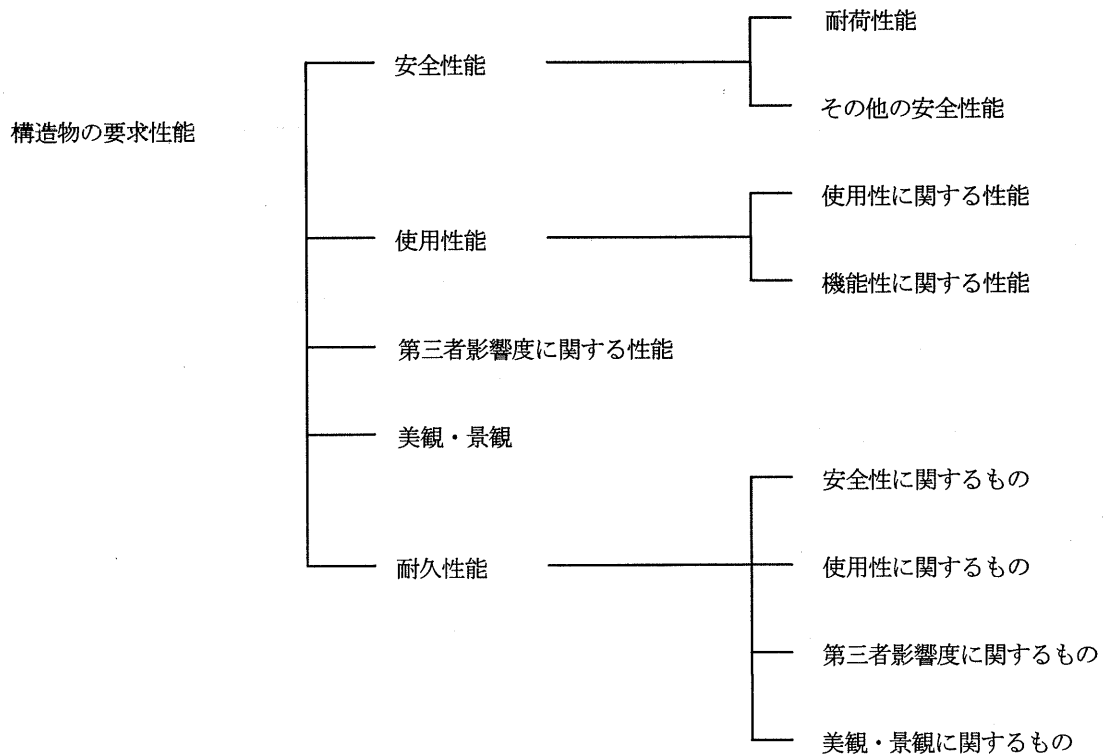
図2 構造物の性能の分類
