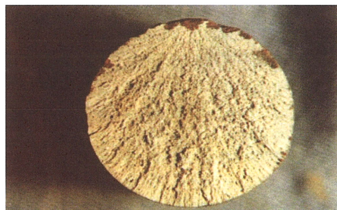
写真-2.4.2 PC鋼棒破断面拡大状況
