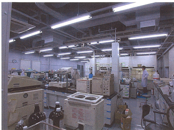
写真-5.2.5 PC梁による研究室大空間確保
