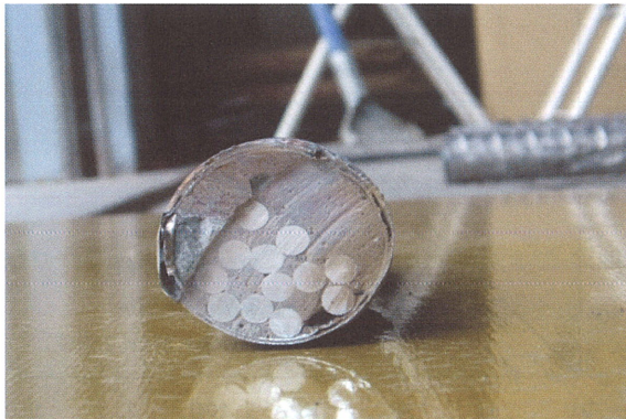
写真-2 鋼材切断部付近のグラウト充填状況 (実験終了後供試体を解体し回収)
