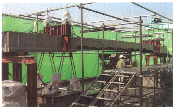
写真-5.2 PC 部材のはつり試験状況 4-12)
