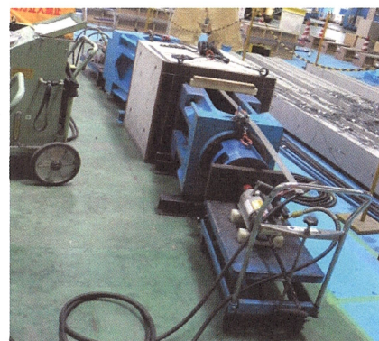
写真-13 引込み試験状況
