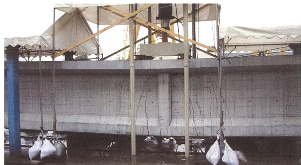
写真－3.3 実物大 PC 鉄道橋模型の載荷実験状況
