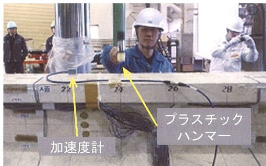
写真-4.7 ハンマによる加振状況
