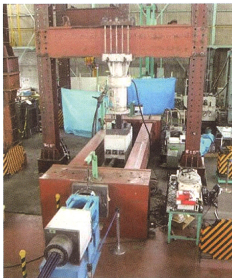
写真-20 フレッシング疲労試験
