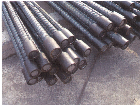
写真-1.9 継手用の加工鉄筋
