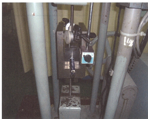
写真-14 2本重ね圧縮試験状況
