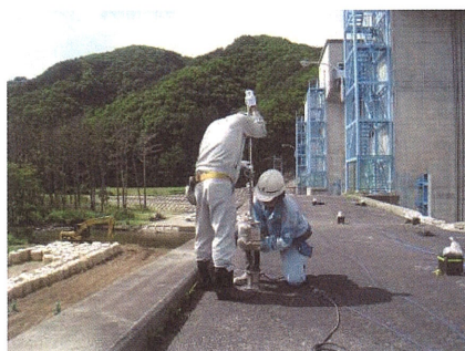
写真-4.6 振動計測状況 (普代水門管理橋)
