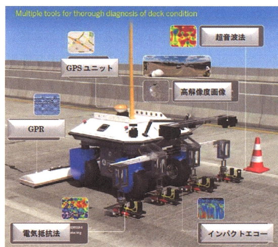
図-3.6.2 道路橋床版非破壊検査ロボット
