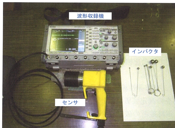
写真-2.2.4 インパクトエコー測定装置
