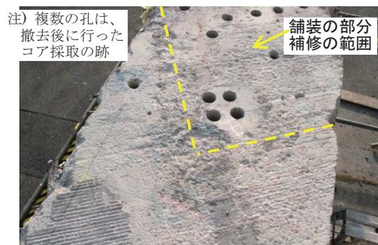
写真-3.4 橋面As舗装の部分補修境界付近における土砂化の兆候（舗装打継目を示す破線は舗装路面写真から推定した概略の位置）<sup>6)</sup>
