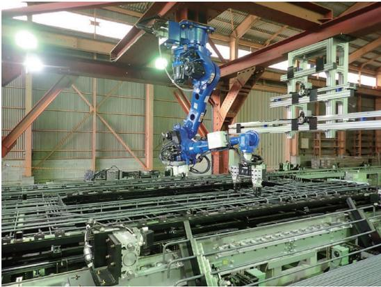
写真-4.13 ロボタラスによる配筋状況
