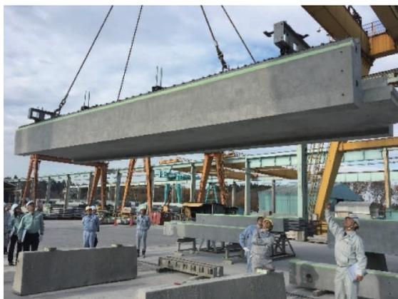
写真-5.3 スパン梁製品検査状況
