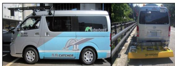
写真-5.7 車載式電磁波レーダ外観
