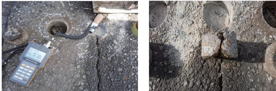
写真-5.12 舗装施工目地箇所の舗装コア採取
