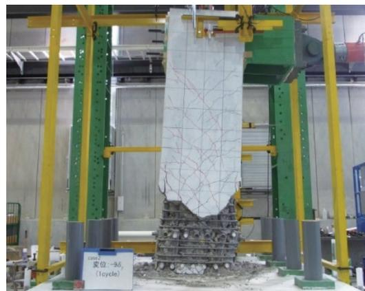
写真-4.11 PCa柱の载荷試験
