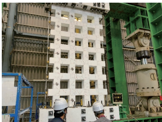
写真-2.4 SPCa 格子壁の実大実験
