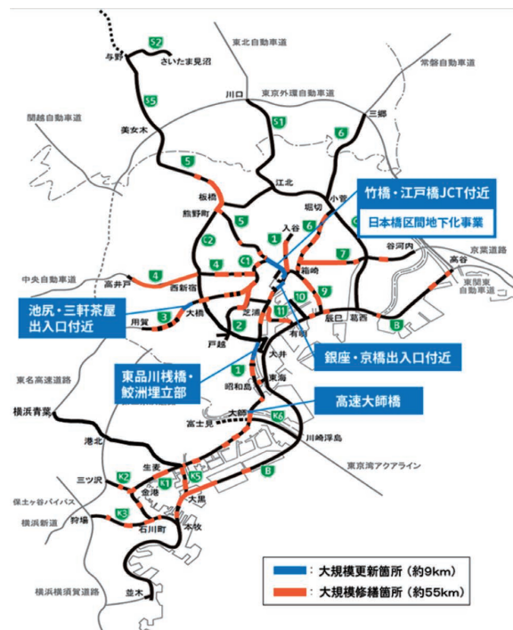
図-2.1.4 首都高速道路の大規模更新・大規模修繕
