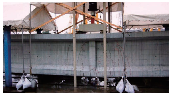
写真-5.3 実物大PC鉄道橋模型の載荷実験状況
