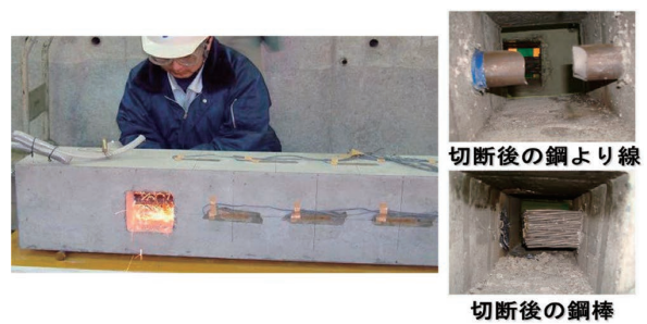
写真-5.2 鋼材破断実験状況
