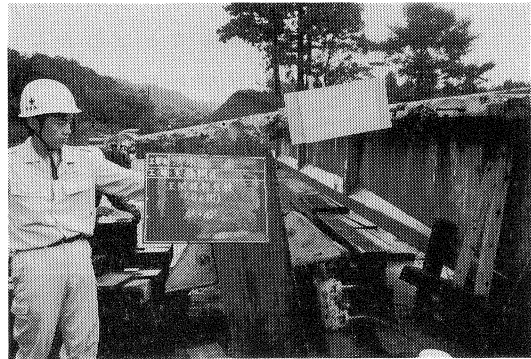
写真-5 主桁傾斜試験
