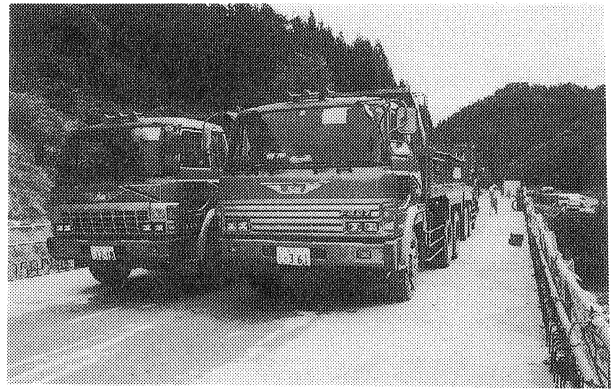
写真-1 静載荷試験状況
