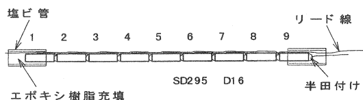
図-3 分割主鉄筋図
