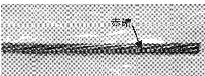
写真-1 表面上に錆の付着した PC 鋼材
