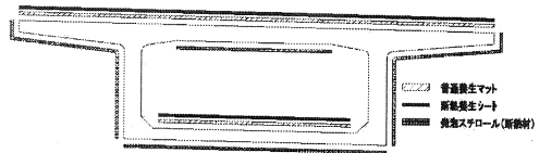
図-4 断熱養生の概要図
