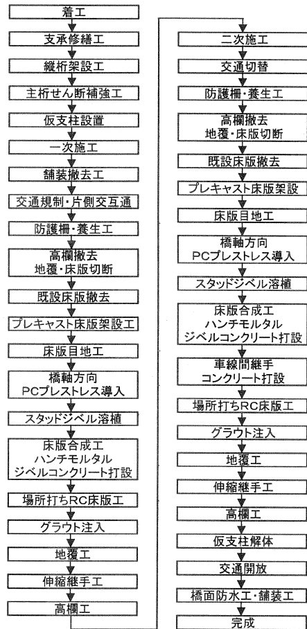
図-6 施工フロー
