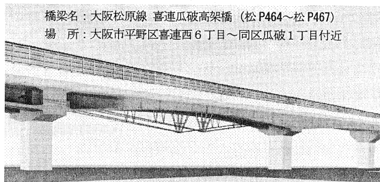
図-1 下弦ケーブル補強工法の概要図
