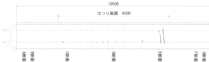
図-10 ひび割れ発生状況(120mmはつり時・STEP5 [除荷後])
