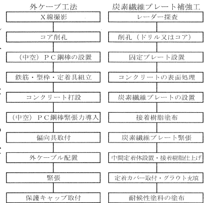
図-5 施工フロー
