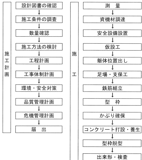
図-2 施工計画および施工の流れ
