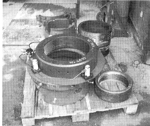
写真-8 張力調整用のリングジャッキ
