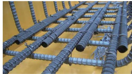
写真-1 重ね継手部の配筋状況
