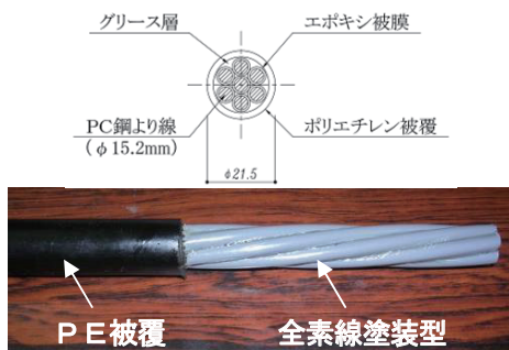
写真-3 重防食PC鋼より線
