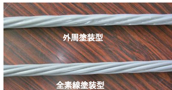
写真-4 外周塗装型と全素線塗装型の外観比較
