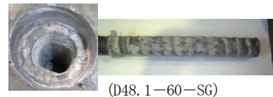
写真-2 SGモード強制付着破壊試験後
