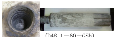
写真-1 GShモード強制付着破壊試験後
