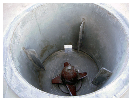
写真-2 ミキサの練混ぜ槽内
