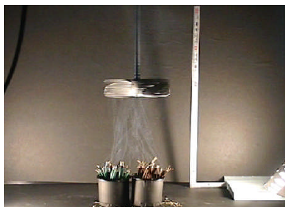
写真-3 攪拌機による煙の攪拌（縦に吸い上げ）
