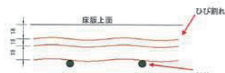
図-3 はつり箇所のひび割れ状況
