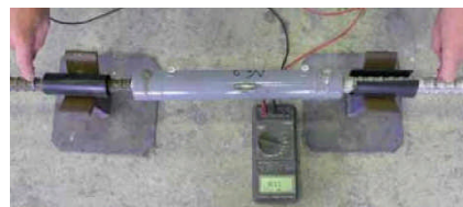
写真-1 機械継手の絶縁性能確認状況
