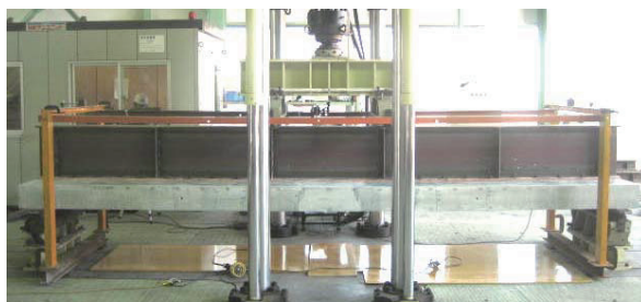
写真-2 曲げ疲労試験状況
