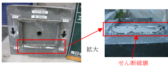
写真-2 PCa 受皿側の破壊形態
