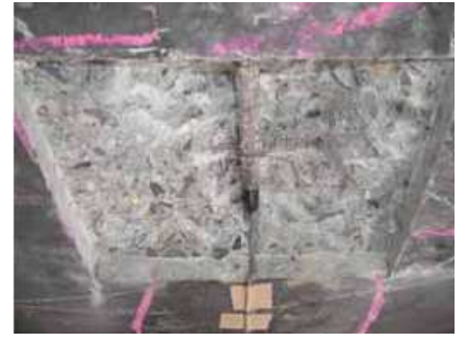
写真-6 応力解放計測
