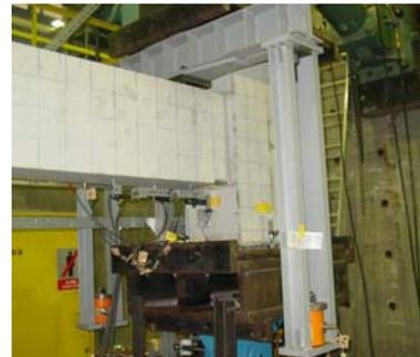
図-7 長期せん断力加力装置図
