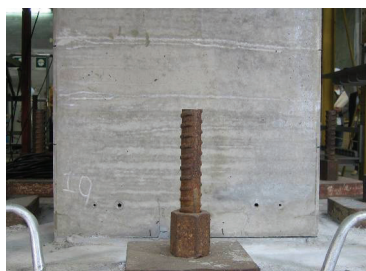
(1) 2階梁端部 (2) 1階柱脚部 写真-1 R=1/67\text{rad} 時における圧着接合部の状況
