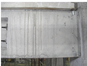
(1) 2階梁端部 (2) 1階柱脚部 写真-1 R=1/67\text{rad} 時における圧着接合部の状況
