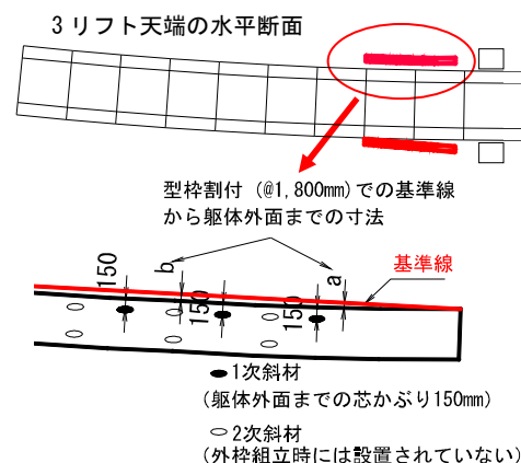
図-11 斜版型枠曲線形状管理方法
