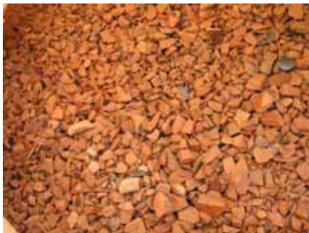
写真-1 廃瓦粗骨材
