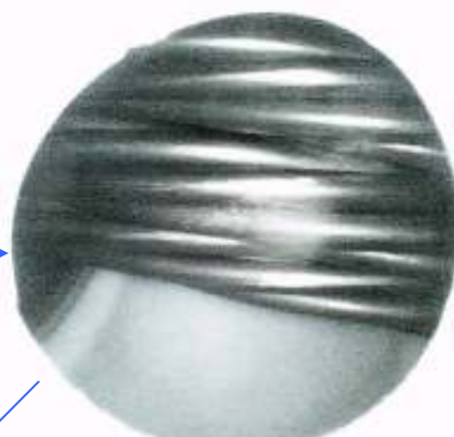
写真-8 シース内充填状況（最高部充填前）
