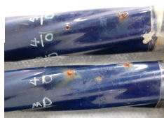
写真-1 連続結露試験後(模擬欠陥部)
