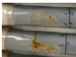
写真-2 連続結露試験後(補修部)
