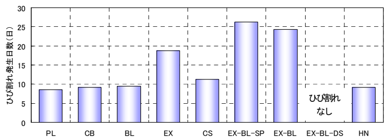
図-5 ひび割れの発生材齢
