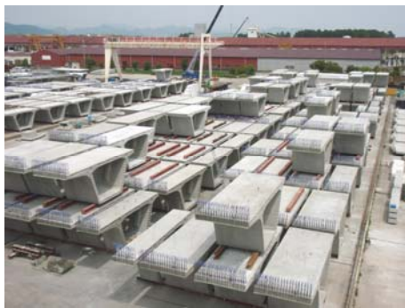
写真-1 セグメントストック状況（工場）
