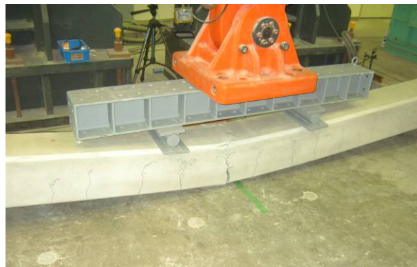
写真-5 RCストラット耐力試験状況
