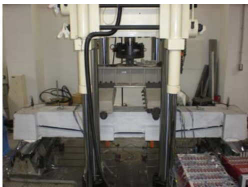
写真-3 載荷試験状況
