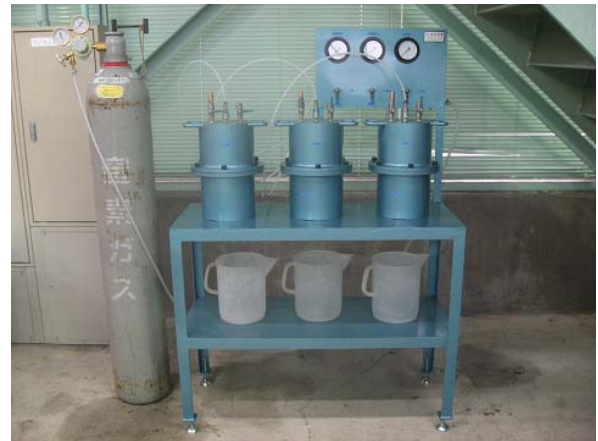
写真-1 透水試験状況
