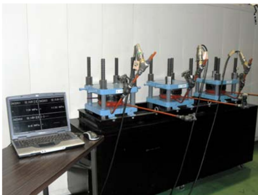
写真-2 揚力保持試験状況
