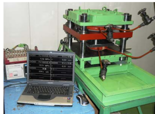
写真-3 一定荷重载荷試験状況
