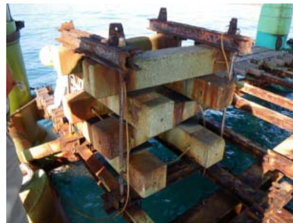
写真-2 供試体暴露状況
