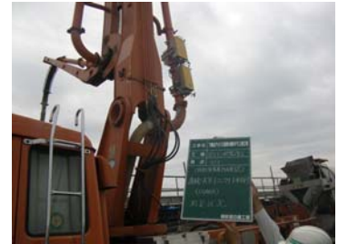
写真-1 連続RIコンクリート水分計
