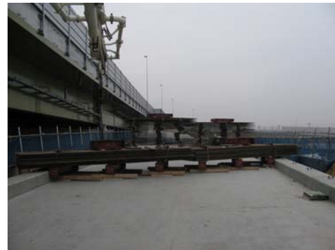
写真-1 実橋での載荷状況
