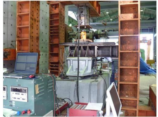
写真-4 鉛直載荷試験
